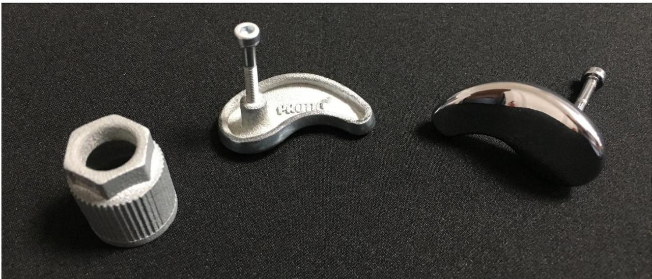
Additiv gefertigte Bauteile mit anschließender Oberflächenbeschichtung in Chrom; Bauteildesign und galvanische Oberflächenveredelung durch die HDO Druckguß- und Oberflächentechnik GmbH
