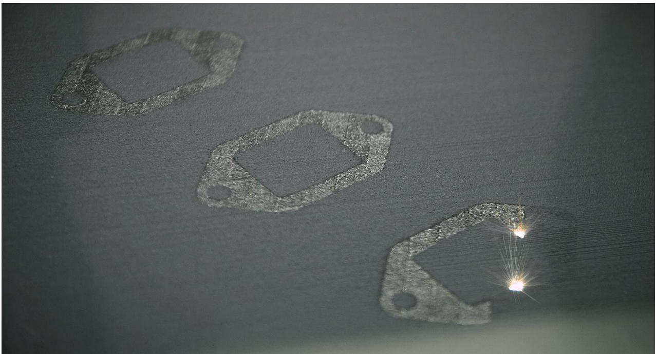
Ein Blick in den Bauraum während des selektiven Laserschmelzens.
