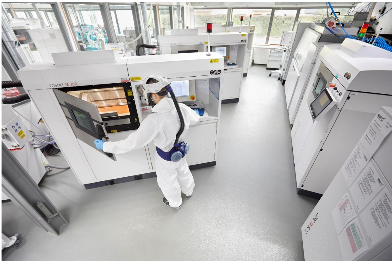
Die Bauteile werden nach dem Fertigigungsprozess von überschüssigem Pulver befreit und aus der Anlage entnommen.
