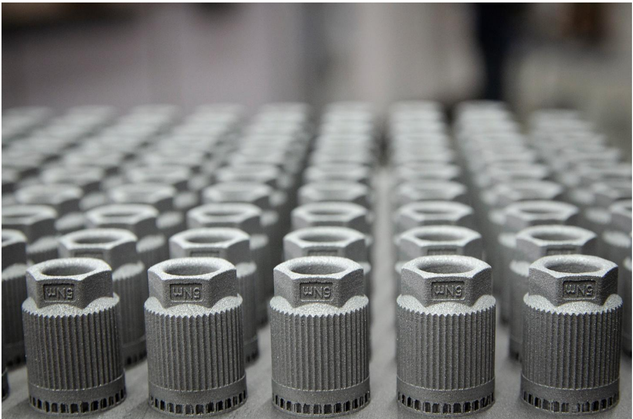
Additiv gefertigte Kleinserie aus Zamak 5.
