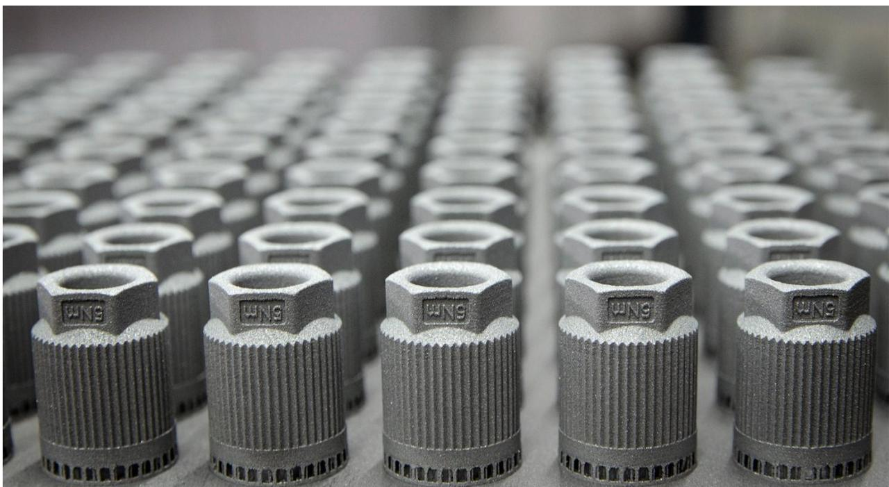
ProtIQ bietet die Serienfertigung von Zinkbauteilen an, bei deren Stückzahl das klassische Zinkdruckgießen noch nicht wirtschaftlich ist. Zusätzlich lassen sich die Vorteile beider Verfahren durch eine innovative Kombination optimal ausschöpfen.
