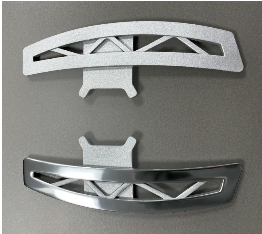
Additiv gefertigte Schaltwippen im Automobil: Wie bei Zamak üblich, lässt sich das Material sehr gut schleifen und poliere - automatisiert oder per Hand.
