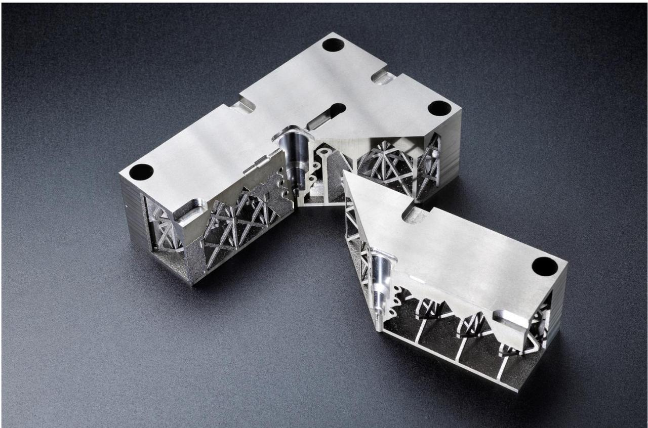
Additiv gefertigte Spritzgießwerkzeuge mit komplexen, konturnahen Kühlkanälen steigern die Performance in der Produktion und reduzieren Zykluszeiten.
