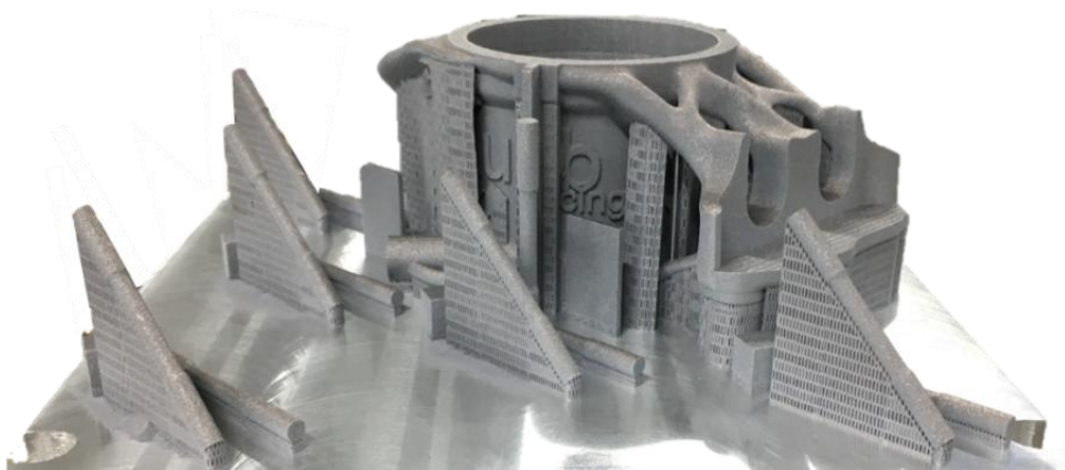
Abbildung 4: Validierung des Qualitätssicherungskonzeptes anhand eines laserstrahlgeschmolzenen Radträgers des Direct Manufacturing Research Center der Universität Paderborn
