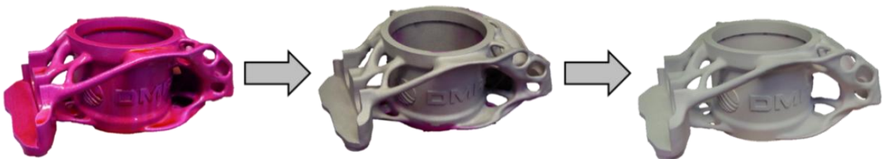
Abbildung 5: Farbeindringprüfung gemäß ISO 3452 am Beispiel eines Radträgers
