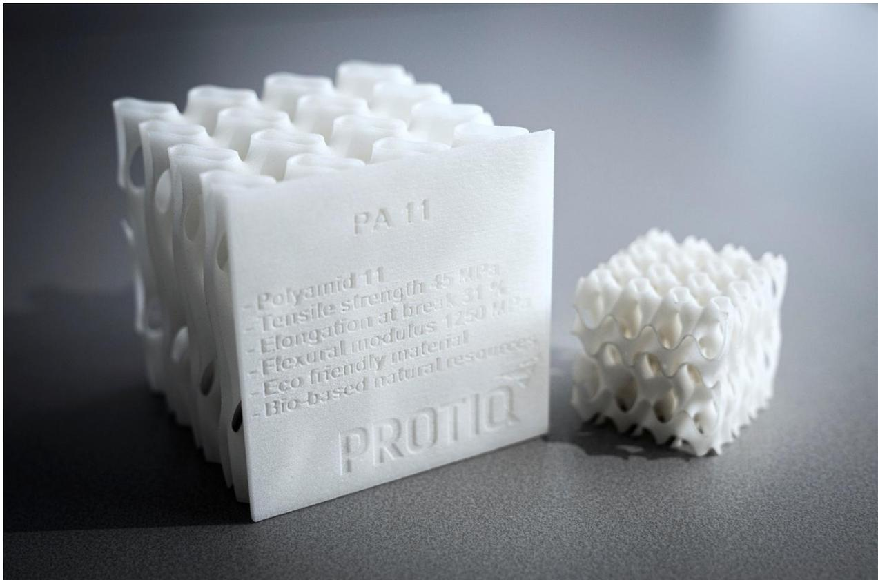
Der neue Kunststoff PA11 zeigt im Zugversuch ähnliche Festigkeiten wie das weit verbreitete PA12. Die deutlich höhere Bruchdehnung zeichnet PA11 allerdings als überlegenen Werkstoff aus. (Quelle: BASF)
