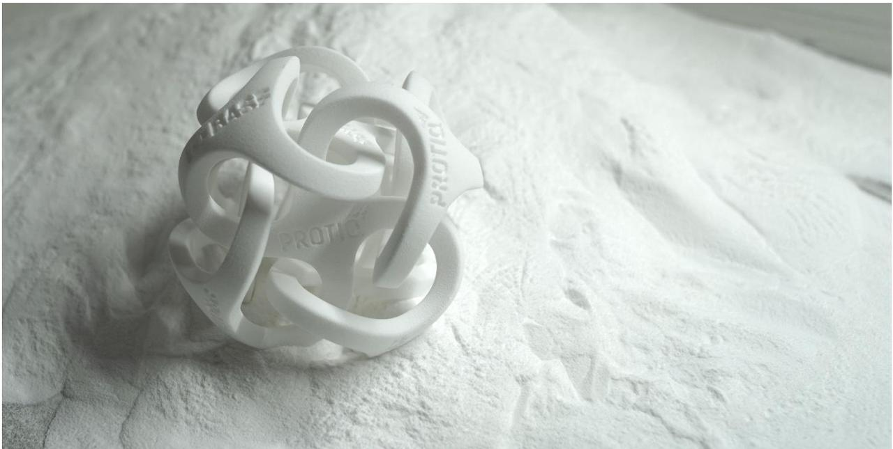
Das SLS-Verfahren ermöglicht die Herstellung hochkomplexer Bauteile und bietet eine große Gestaltungsfreiheit bei der Entwicklung.
