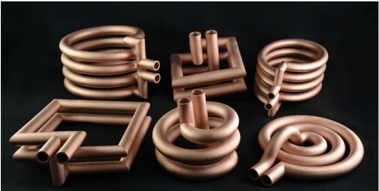
Der von ProtIQ entwickelte Prozess zur Verarbeitung von hochleitfähigem Reinkupfer im selektiven Laserschmelzprozess erlaubt die Herstellung innovativer Bauteile für die Elektroindustrie
