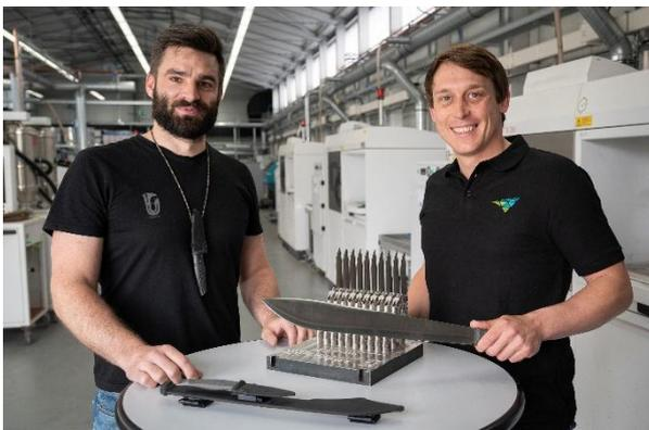
Jan Gierse (UG-Tools, links) und Johannes Lohn (ProtIQ, rechts) präsentieren hochwertige Messer und Klingen der Messermanufaktur. Diese werden mit 3D-gedruckten Griffen aus Titan oder vollständig aus 440C additiv gefertigt.
