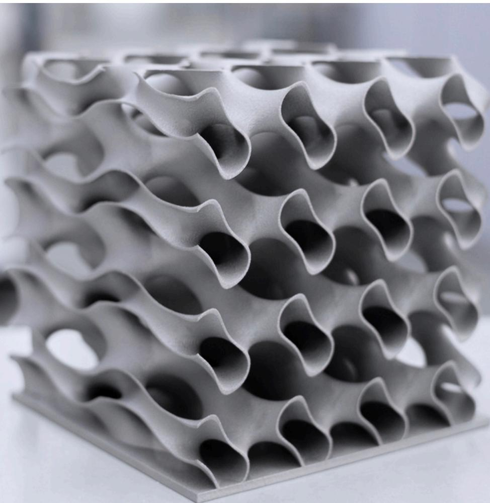
Die Herstellung von Prototypen aus Zink erforderte bislang viel Zeit und Geld. Mit Hilfe der additiven Fertigung lässt sich dieses Problem aber nun lösen: Durch einen von PROTIQ entwickelten Prozess lassen sich Bauteile aus Zamak 5 jetzt 3D-drucken.
