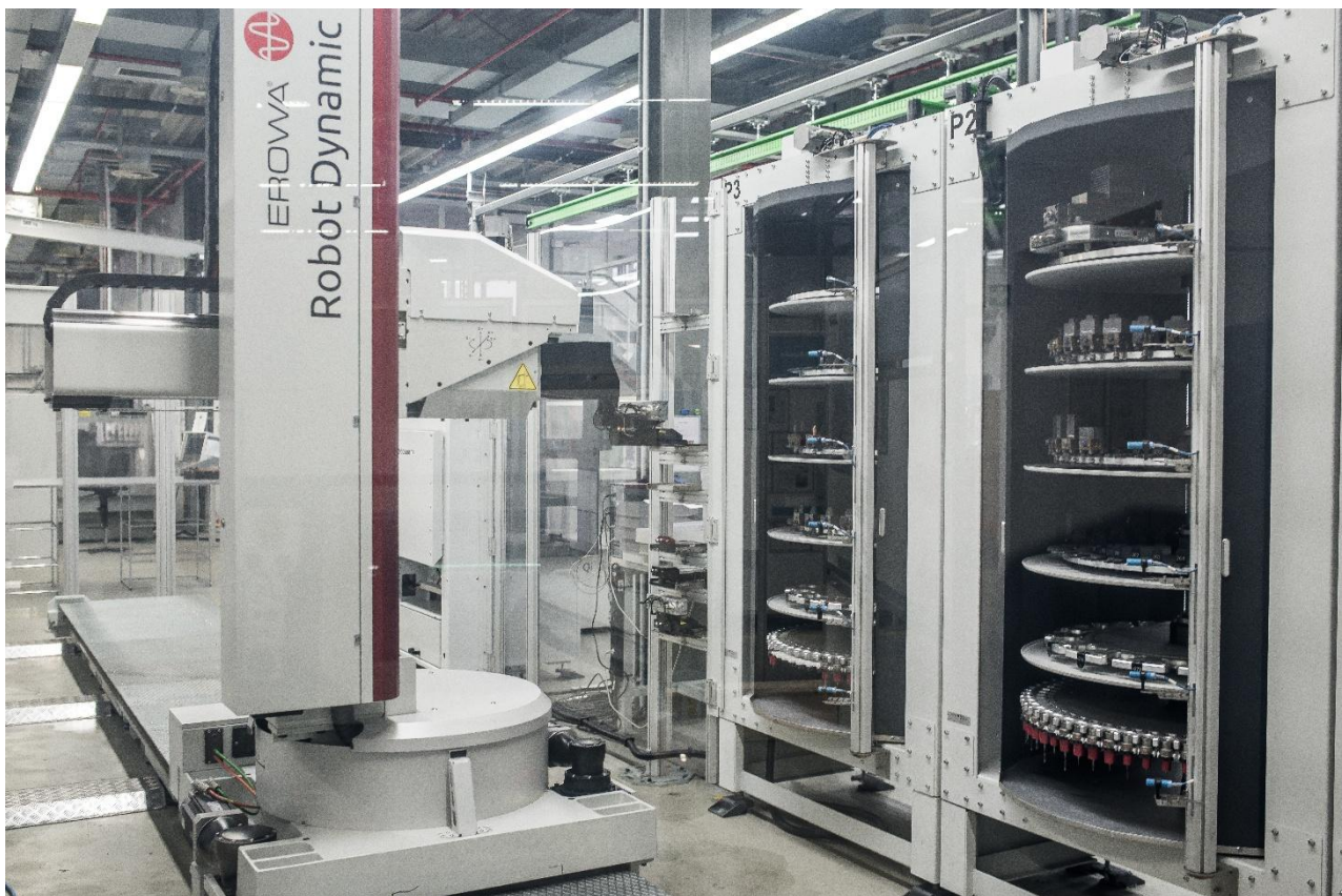
Voll verkettete, automatisierte Produktionszelle im internen Werkzeugbau der Phoenix Contact GmbH & Co. KG als Beispiel für eine konsequente Umsetzung der Industrie 4.0.
