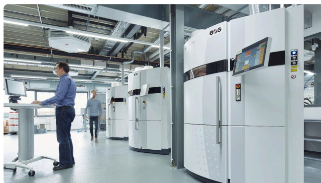
▼ Grazie alla movimentazione automatizzata delle polveri, gli impianti di sinterizzazione laser di materie plastiche vengono alimentati in modo continuo con polvere di processo
