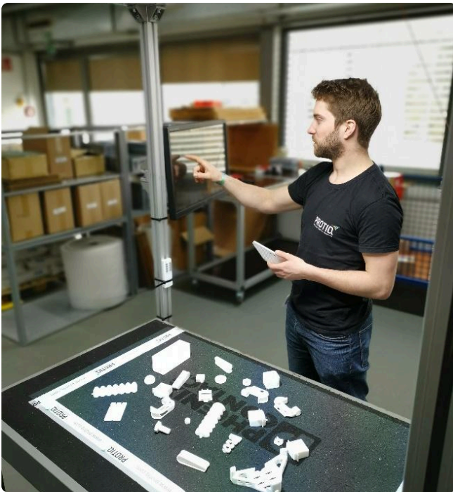
▼ Bei der automatisierten Bauteilerkennung wird industrielle Kamera-technik für die visuelle Erfassung unterschiedlichster Geometrien verwendet. Durch Interaktion mit einem Touchdisplay können über einen Beamer für jeden Auftrag die korrekten Bauteile farblich markiert und sortiert werden
