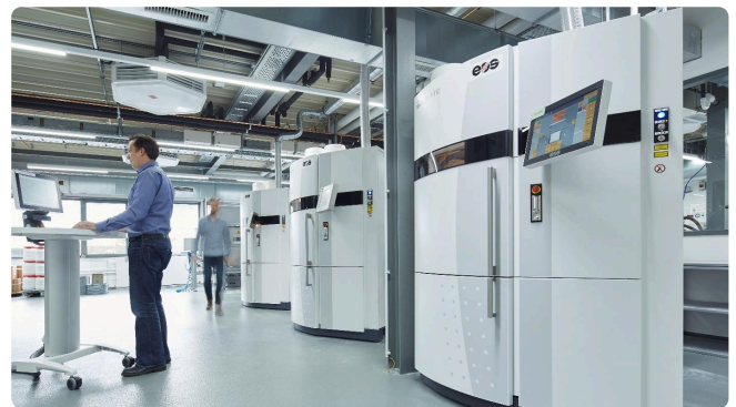
▼ Durch das automatisierte Pulverhandling werden die Anlagen im Bereich des Kunststoff-Lasersinterns kontinuierlich mit Baupulver versorgt
