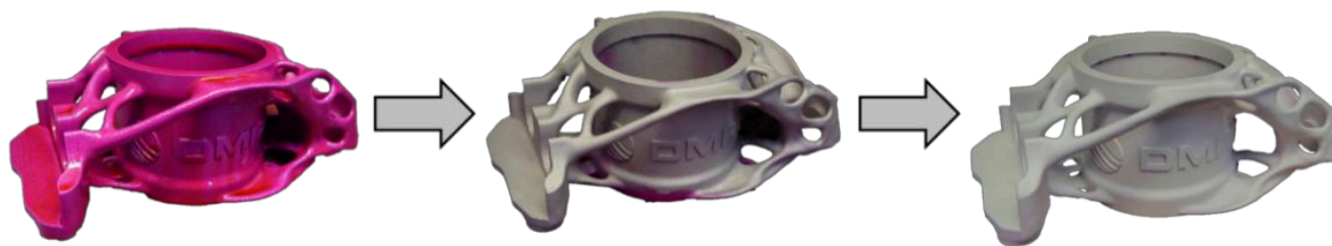
▼ Figura 5: Controllo con liquidi penetranti secondo la ISO 3452 sull'esempio di un portamozzo
