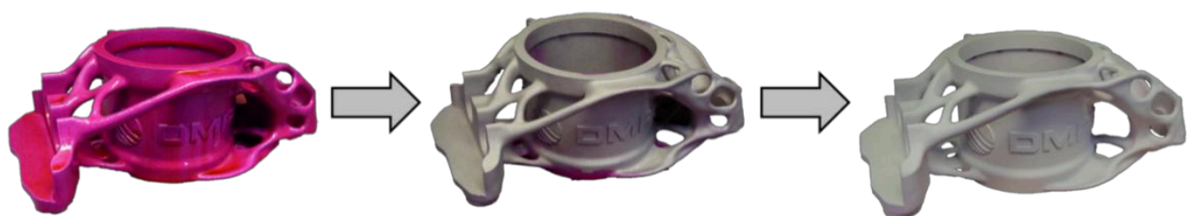
▼ Abbildung 5: Farbeindringprüfung gemäß ISO 3452 am Beispiel eines Radträgers
